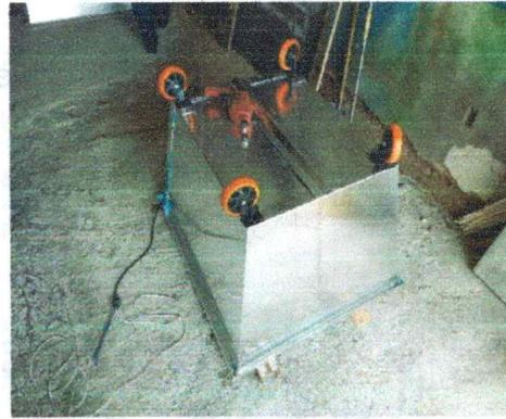
Suministro de bandeja recolectora lodos prensados en aluminio
