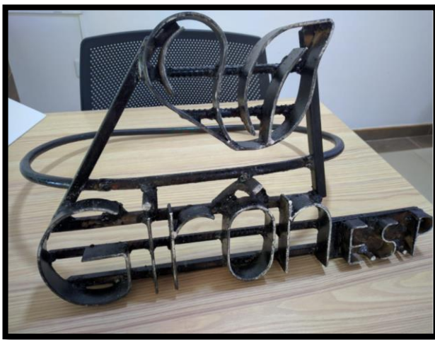
Fabricación de estructura metálica tipo molde con el logo institucional para la marcación de tapas y estructuras en concreto.
