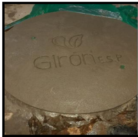
Fabricación de estructura metálica tipo molde con el logo institucional para la marcación de tapas y estructuras en concreto.
