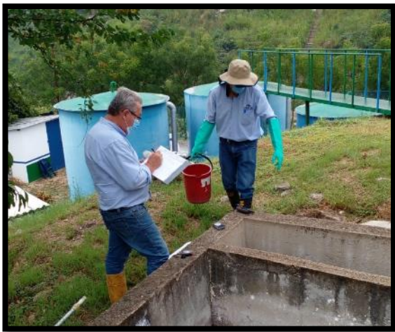
Toma de muestras fisicoquímicas, para caracterización y parametrización de los niveles actuales de las aguas tratadas.
