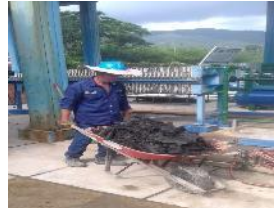
Extracción de lodos por filtro prensa
